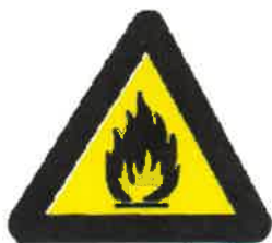
Εύφλεκτες ύλες ή υψηλή θερμοκρασία
